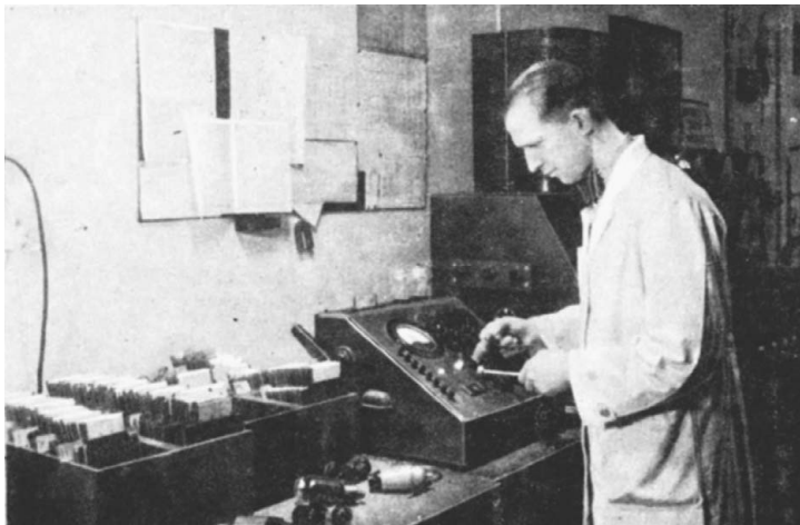
Für die Röhrenprüfung steht ein großes Röhrenmeßgerät mit auswechselbaren Meßkarten zur Verfügung.
